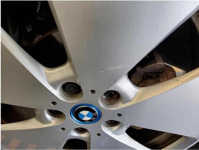
Felge (Sommer-Radsatz) - Vorderachse links - leicht beschädigt, Gebrauchsspur
