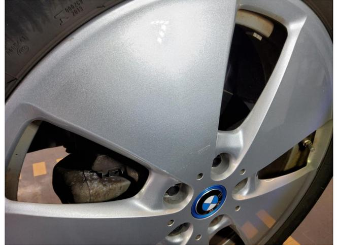
Felge (Sommer-Radsatz) - Vorderachse rechts - leicht beschädigt, Gebrauchsspur
